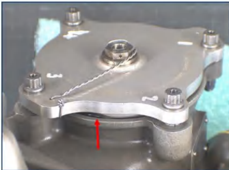
图 3 LEAP 发动机主滑油滤端盖松脱产生间隙
