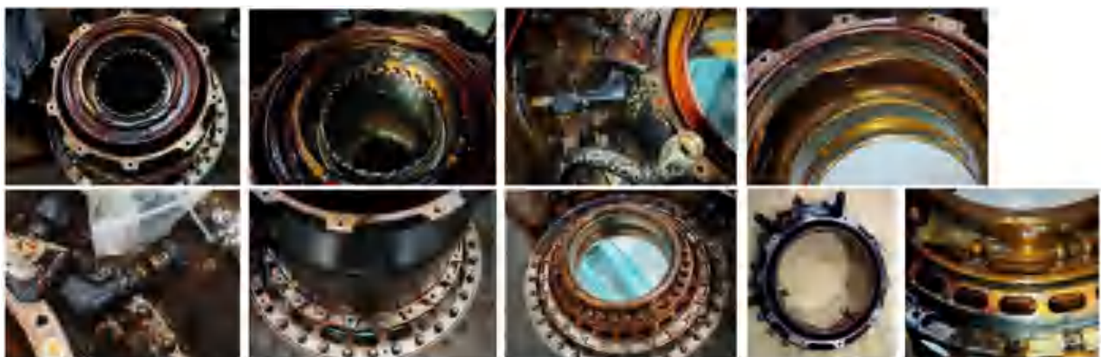
图五 LEAP-1B 收油池 B 区域积碳与油迹
