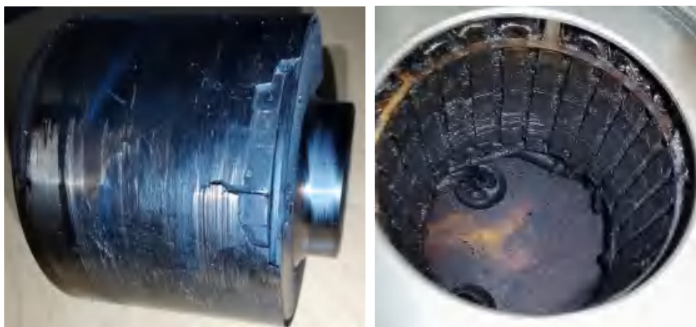
图 8. EEC 发电机转子和静子磨损
