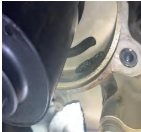
图 9. EEC 发电机安装区域金属屑
