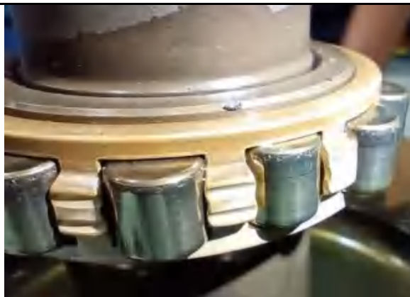
图 12.47 齿滚棒轴承磨损
