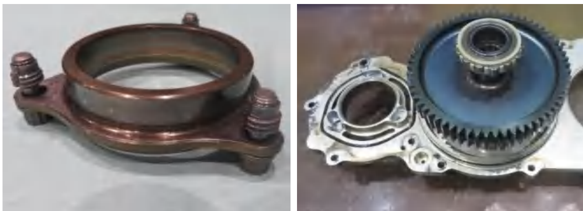
图 11. 47 齿滚棒轴承外轨道固定螺栓和螺套脱出、起动机驱动盘磨损
