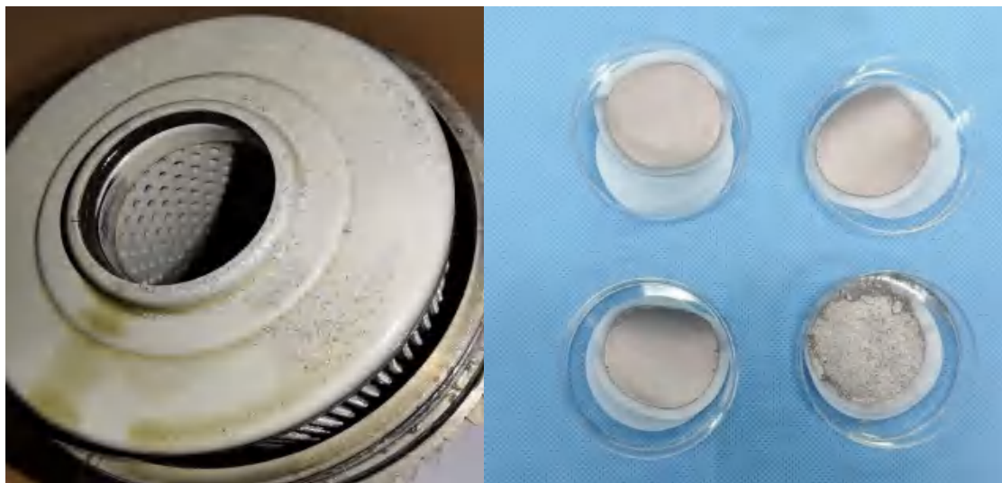
图 10. 滑油回油滤金属屑
