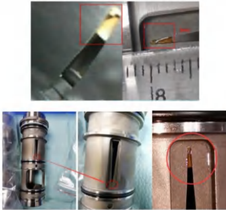
图 1、HMU 内的 FMV 出口窗处存在外来物
