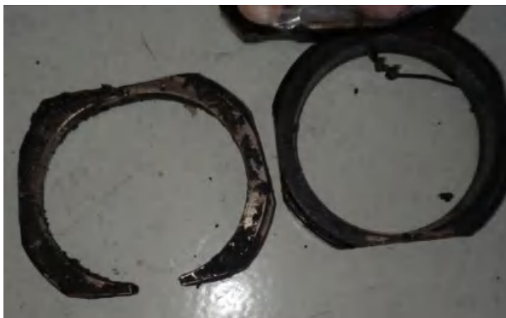
图 9、支撑卡环变形
