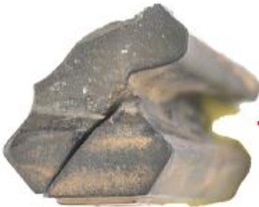
榫头小颈裂纹向下扩展引起上压力面应力集中导致叶片断裂
