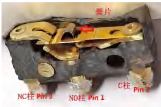
PIN 2-1 接通, 电门正常位
