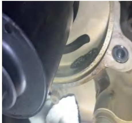
图 9. EEC 发电机安装区域金属屑
