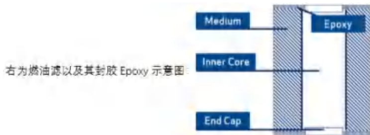
图 4、燃油滤及密封胶
