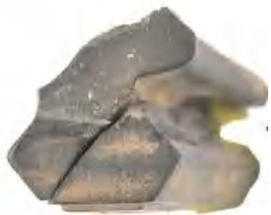
向下扩展后上压力面应力集中断裂
