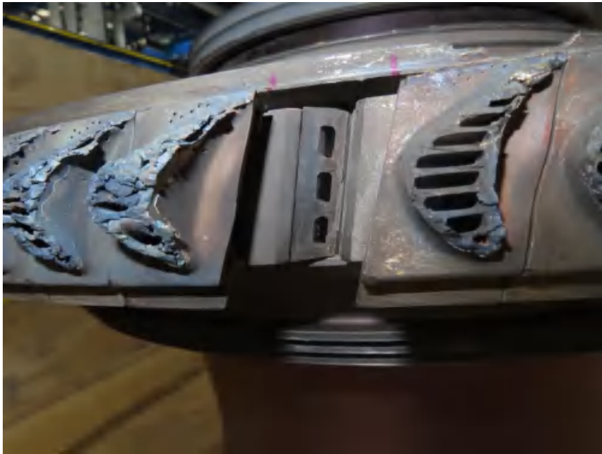
658561 断裂高压涡轮叶片进厂状态
