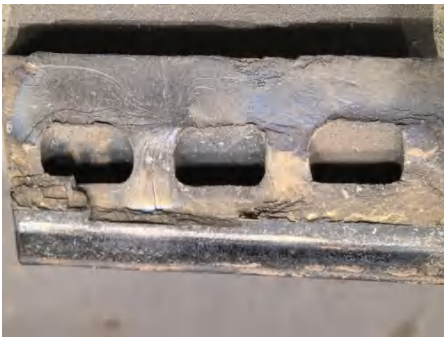
658561 断裂高压涡轮叶片的断口形貌
