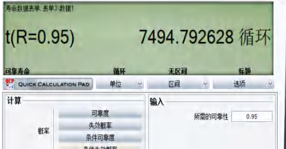
图 3、95%可靠度情况下，滑油滤旁通灯亮事件或故障发生时机
