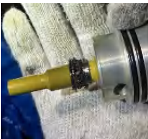
图 7. AGB/TGB 磁堵碎屑
