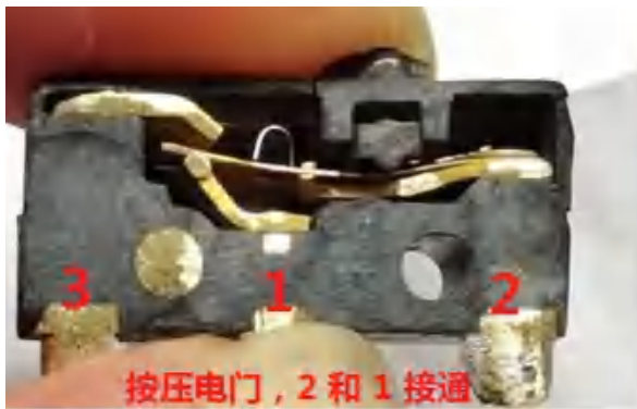
PIN 2-1 接通, 电门正常位
