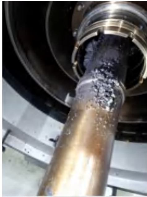
图 8、CVT 上的滑油积碳
