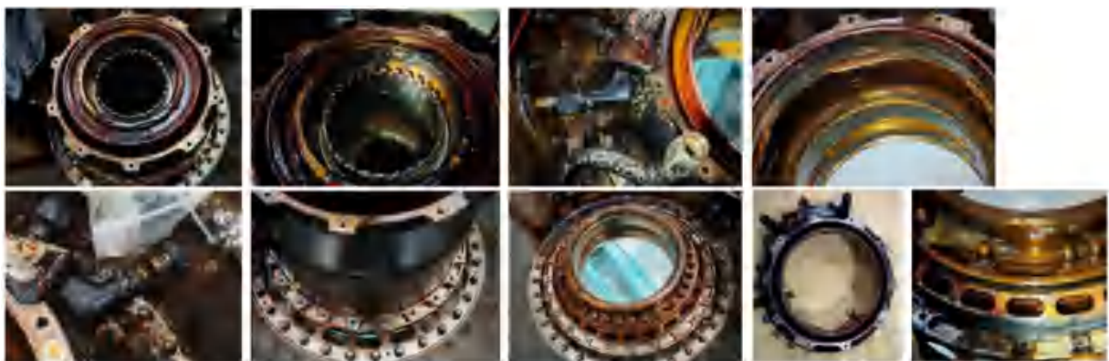
图五 LEAP-1B 收油池 B 区域积碳与油迹
