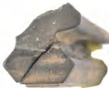
向下扩展后上压力面应力集中断裂
