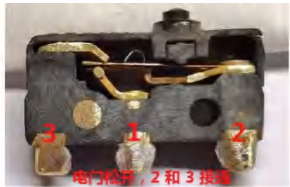
PIN 2-3 接通, 电门堵塞位
