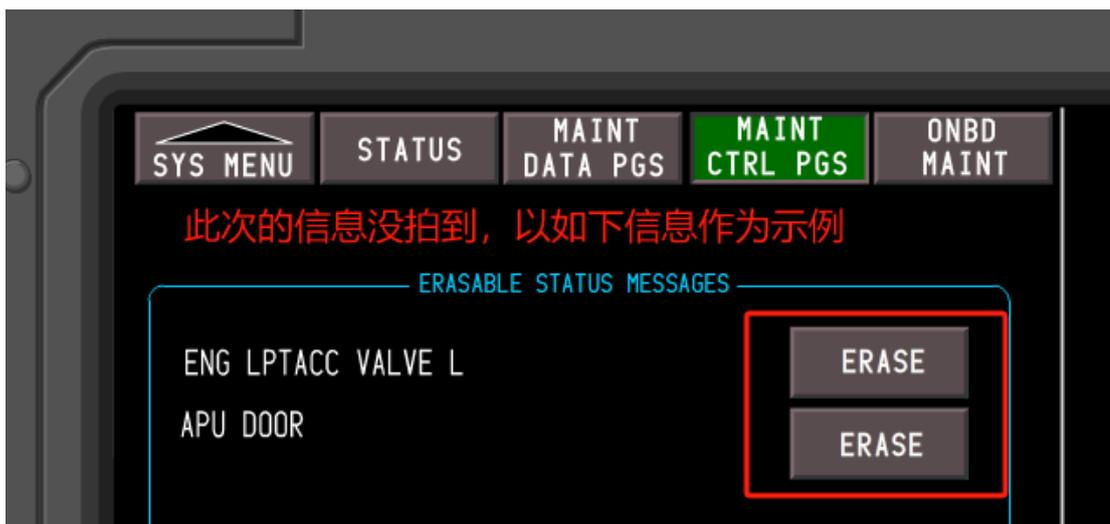
3、完成信息清除后，此时 MAINT 灯应该已经熄灭，同时 STATUS 页面已没有信息，这时候让机组再尝试启动发动机，若启动正常，可正常执行航班。
