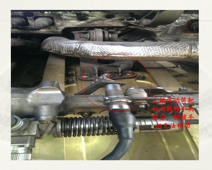
若反推滑轨与滑块正常,且出现了上锁作动筒靶标与手柄卡死的情况,那么我们就需要将排故重心放 在上锁作动筒和同步锁上。
