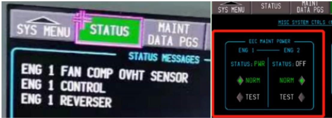
因此需注意只有 ENG 1 CONTROL 状态信息，没有维护信息时，通常认为是在 MSC 页面 EEC 维护电源选择 TEST 后飞机断电导致的**虚假信息**。由于飞机断电后，EEC 测试通电选择 TEST 后并不会自动变回 NORM，完成 EEC 通电工作后，注意将 MSC 页面的 EEC MAINT POWER 设置到 NORM 位，可避免虚假信息出现。
