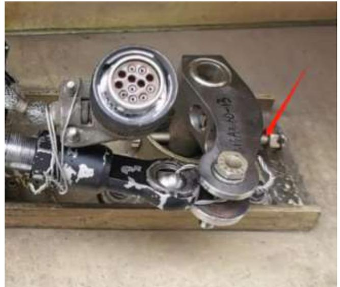
5、用保险丝将作动筒杆端固定到曲柄轴的安装螺栓上
