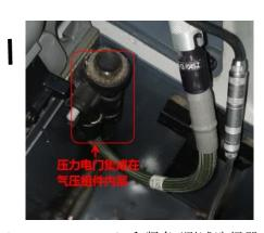
氧气面罩盒内安装有一个压力电门,同时按压复位/测试电门(TEST AND RESET)和紧急/测试选择器 (MERGENCY/TEST),使氧气持续流过。如下图红框内的压力电门,在感受到大于 45PSI 压力后会闭合,给 ACP 信号,使得通讯从吊杆耳机切换到氧气面罩。
