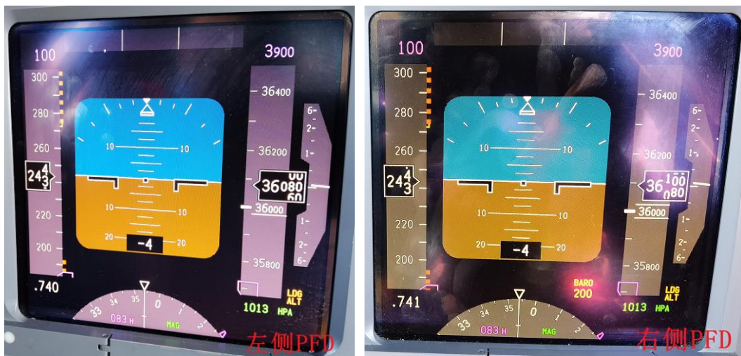
图 6. 地面打压测试
