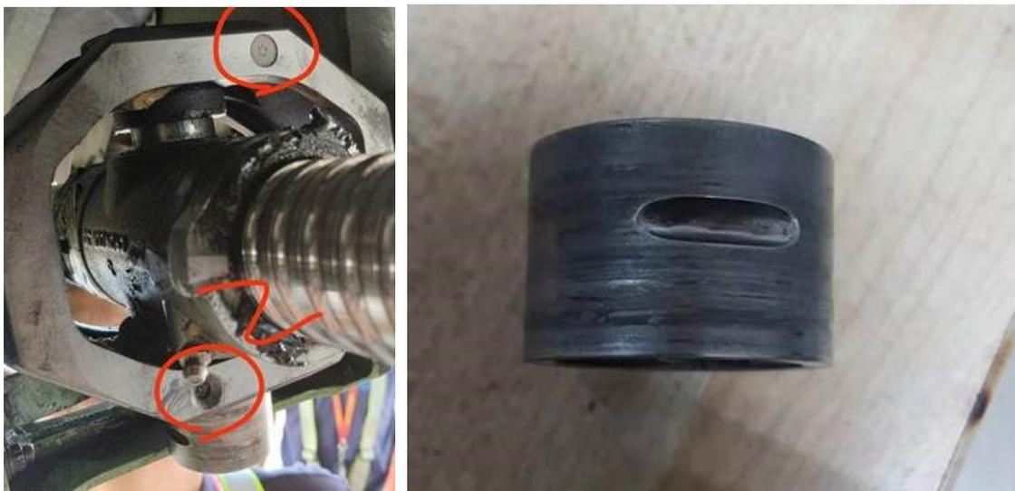
2, 此类缺陷在机队中有过类似的案例，统计机队运行中的情况，相关事件清单如下所示。因为这个衬套是使用螺栓穿过其本体析出来的凹槽固定，从故障表象上看均是安装螺栓丢失导致的衬套跌落，分析可能性成因是由于高振动导致的磨损断裂。这个问题在机队也是广泛存在，运行中反映基本上 1 年 1-2 起。而更多的磨损通过 C 检检查发现。在检查工卡中加入了间隙的检查要求，当磨损超标时更换。年均 30 起以上。我们的分析认为设计问题，这个螺栓是带镀层的普通合金钢，长期振动磨损情况下被剪切，导致脱落。
