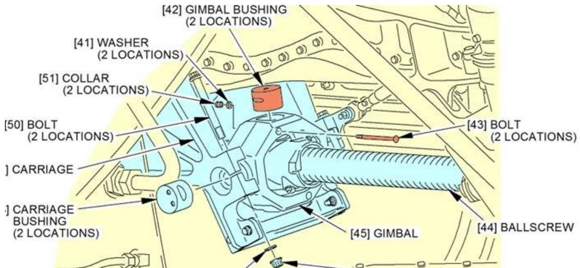
3, 厂家也接到过其他相关运营人的反馈, 并于 2017 年发布了 737NG-FTD-27-17001, 相关报告均反映蜗杆万象轴的下部衬套丢失, 螺钉断裂, 厂家认为该失效的基础原因构成较复杂, 一直在调查中, 2021 年的初步调查表明, 组件上向下的载荷会损坏下部的螺栓, 从现有的数据看, 波音认为是滚珠螺母对下部衬套施加了较大的向下的力, 作用到螺栓上, 损坏螺栓, 但具体原因还不清楚, 波音正在考虑解决方案, 包括额外的定期检查和更换紧固件材料。由于波音尚未明确根本原因, 因此将使用使用性能更强的紧固件替换, 紧固件由镍合金支撑, 有更大的抗剪切性能, 如果客户遇到多次螺栓断裂的情况可联系波音。波音在 2021 年收集是否有客户愿意参加试验, 当时机队拟使用 20 架作为实验, 但波音要求的按不同时间周期作为拆换返回, 给机队管控会带来很大的难度, 未加入计划。新的紧固件备件在 2021 年 5 月可采购。
