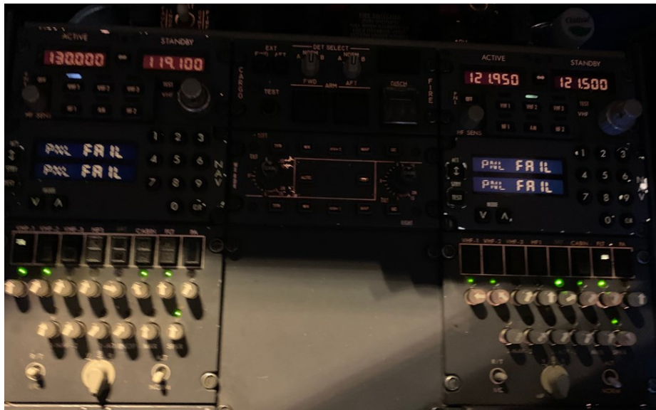
图 2. 两部导航控制面板显示 PNL FAIL
