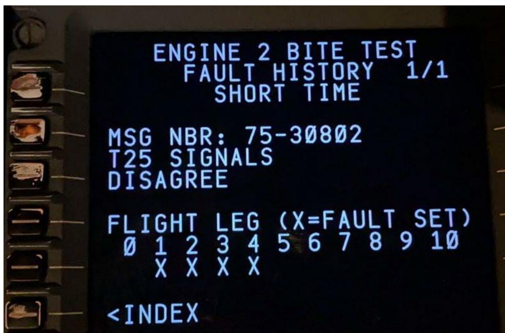
该机在 1-4 段均连续出现，而在 0 段没有，飞机当晚是 23:02 落地深圳，到达桥位是 23:09，落地共滑行了 7 分钟，航后没有做任何试车工作，所以 EEC BITE 中的 0 段，指的就是落地 30 秒到关车的这一阶段。表明故障在地面滑行的低功率阶段是没有的，从而很可能与高功率情况下的振动或者高温相关。
