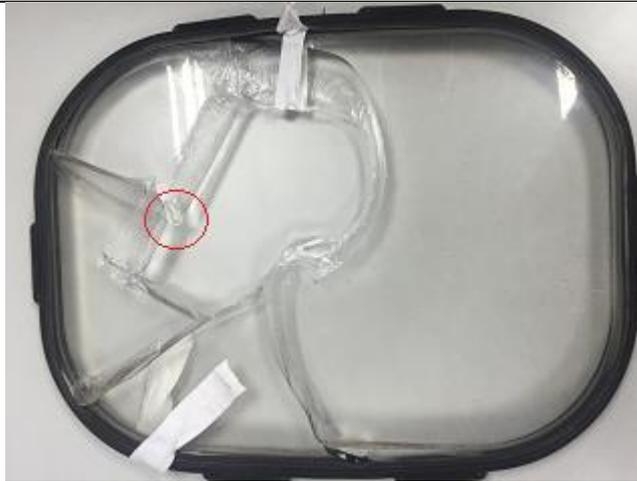
这种概率非常小，实际上飞机窗户的双层设计也确实足以确保客舱增压的正常。
