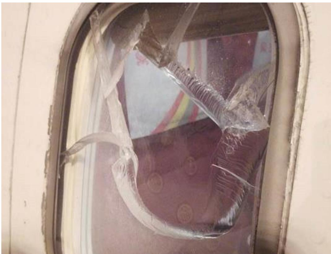
玻璃送波音原厂做了分析，波音认为是飞机在起飞过程中，收到 FOD 的击伤，出现了小的裂纹，在起飞后内外压差的作用下扩展而形成的，撞击点在如下切口位置。
